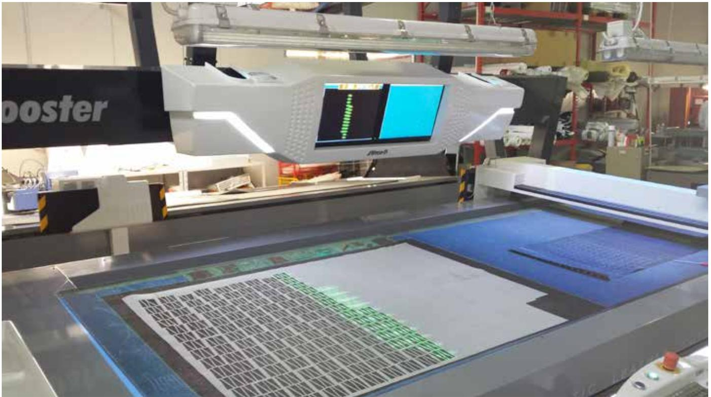
abbiamo acquistato il sistema Booster, di cui abbiamo ben 5 installazioni nella nostra azienda. La macchina è fatta apposta per la produzione. L'area di lavoro è formata da un piano settorizzato che garantisce, attraverso un sistema di aspirazione, la perfetta adesione dei materiali da tagliare. Il carrello multi utensile formato da 2 lame elettriche, 3 perforatori, una penna e un punzone, garantiscono una grande qualità nel taglio di tutti i pellami”.
